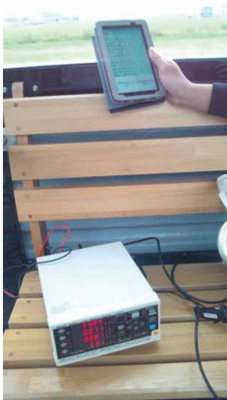
図 4.2-2 計測用の多機能携帯端末と電力計
