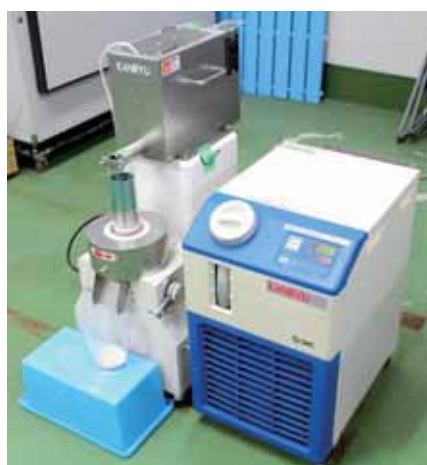
写真13. 高性能粉砕機 (KP505) +冷却機 (KS018、カンリウ工業製)
