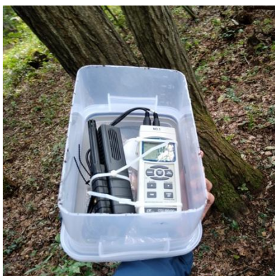
図 5.2-1 ロガーを設置した密閉式チャンバー
