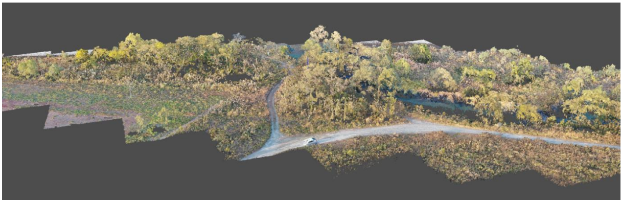
図 1.3-3 オルソ画像から生成した 3次元点群画像
