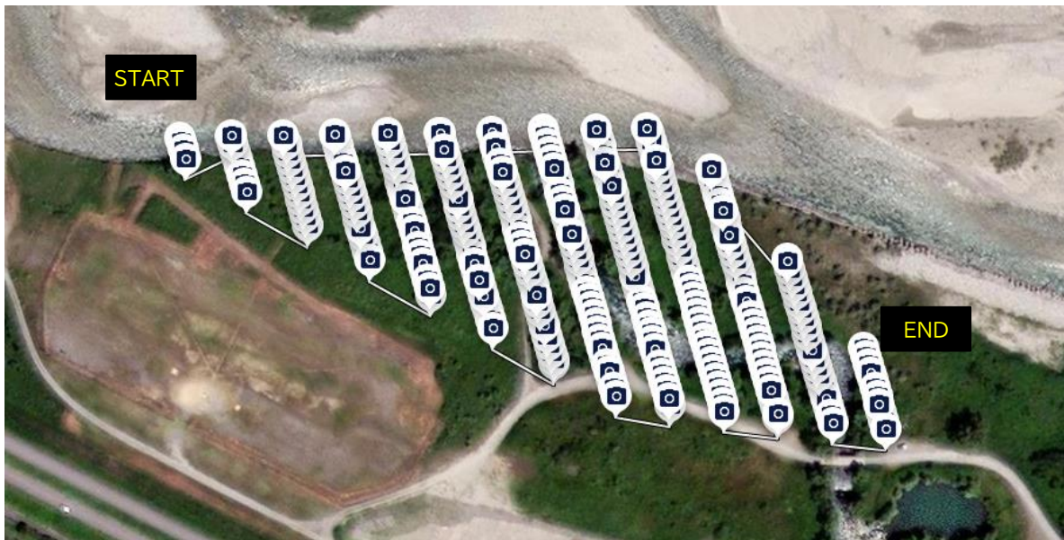
図 1.2-4 撮影地点における自動飛行による空撮軌跡。写真左上から順に自動的に撮影しながら移動させた。撮影時のオーバーラップ率は試行錯誤によって 60%とした。この地点では 600 枚の空中撮影を行った。
