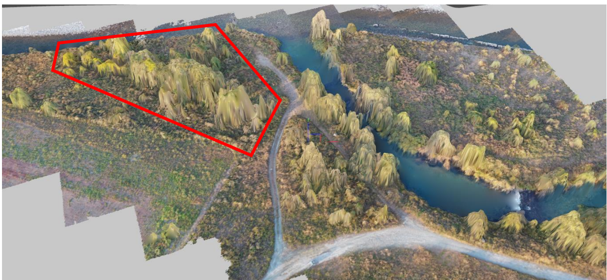
図 1.3-4 点群から生成された DSM 画像。左上の赤枠部分を選択して容積計算に供した
