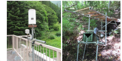
栢尾小学校に設置した雨量計と湧水観測機
