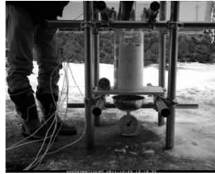
写真4：高温土砂による融雪実験
