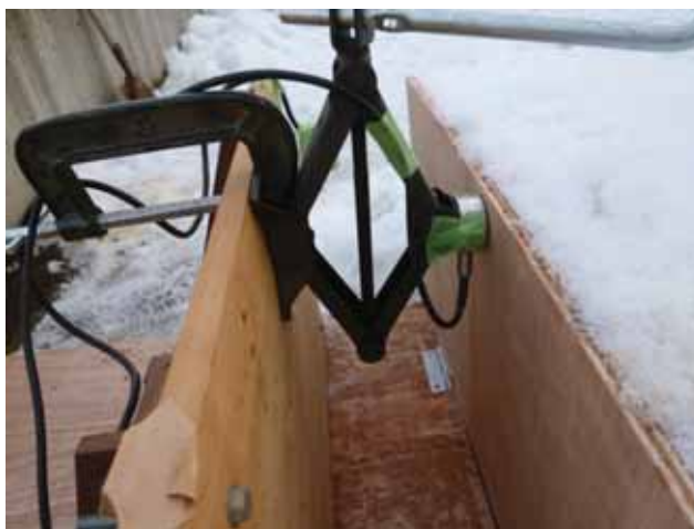
付写 1-1-1 雪壁反力の実験，加圧ジャッキーと荷重計
