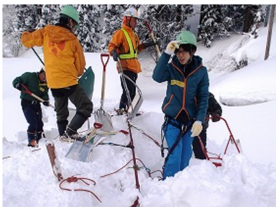
写真8 ガス管式アンカーの実証実験
