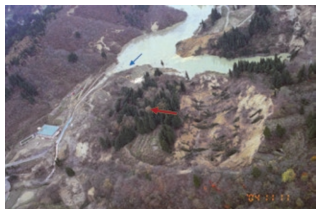
写真2 平成16年中越地震で発生した東竹沢地すべりによる河道閉塞（芋川が閉塞し上流側に湛水池が形成された）
