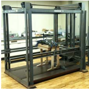
椅子・机の繰り返し衝撃試験（耐久試験）
