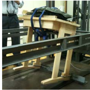
椅子・机の繰り返し衝撃試験（耐久試験）
