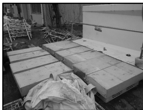
写真-1 大型供試体暴露状況
