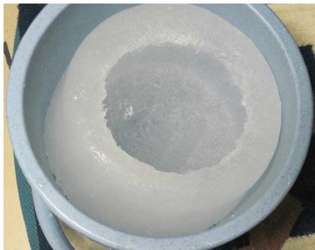
図 3 左：微量の硫酸を含む水（汚染水、導電率 3.6mS/cm）の凍結によりできた透明な氷 右：0.1%の NaCl を含む水（汚染水、導電率 10mS/cm）の凍結によりできた白っぽい氷
