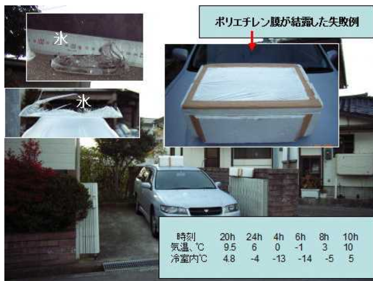
図 9 放射の放出による冷却と冷却箱内に製氷された氷
