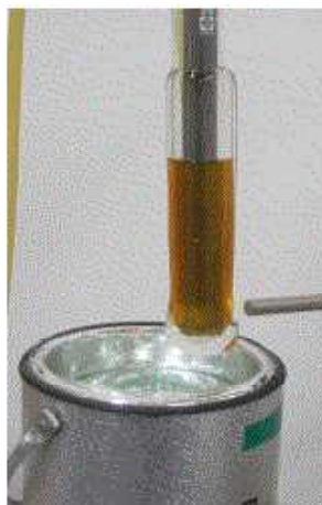
図 4 冷却管の周りに氷を発生させる氷結晶法（予備試験）
