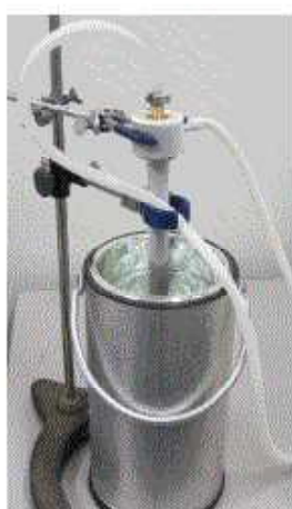
図 4 冷却管の周りに氷を発生させる氷結晶法（予備試験）
