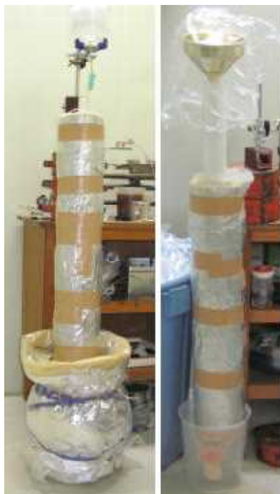
図8 トリチウム水分離を試みるカラム法
