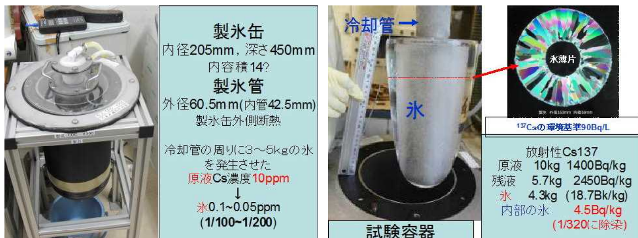
図5 セシウムおよび放射性セシウムを含む汚染水から製氷
