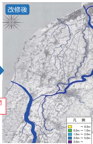
図11 大河津分水路の改修実施前後の浸水被害軽減効果
