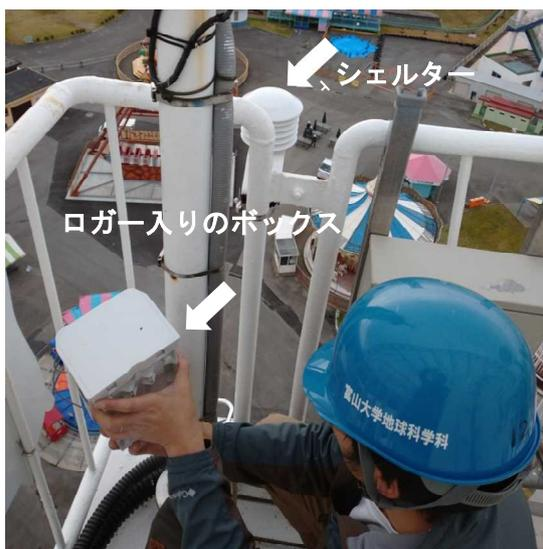
写真1 設置時の写真（中央上の丸い筒がシェルター、左がロガー入りのボックス）
