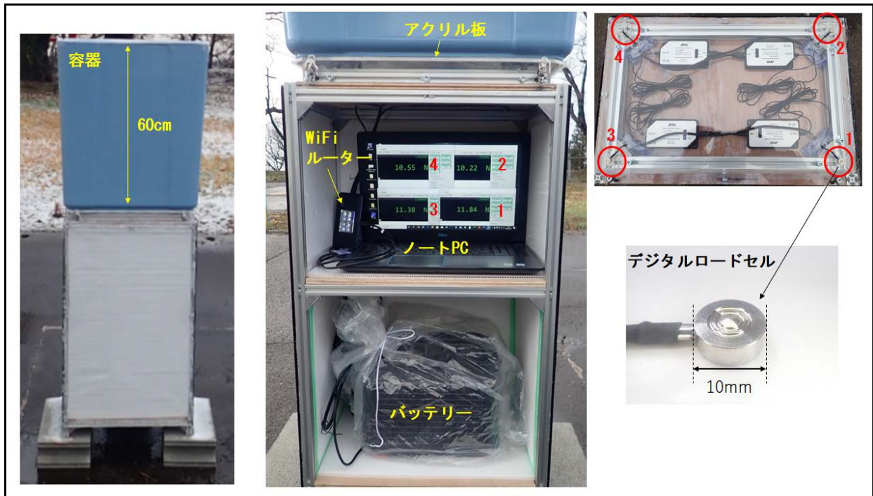
図2 新たに開発した降雪重量計
