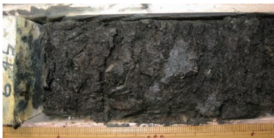
図1 腐植土層のボーリングコア写真 (新潟市江南区天野、深度6.5m付近)
