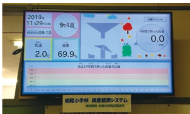
図-1 廊下に設置された雨量表示モニタ
