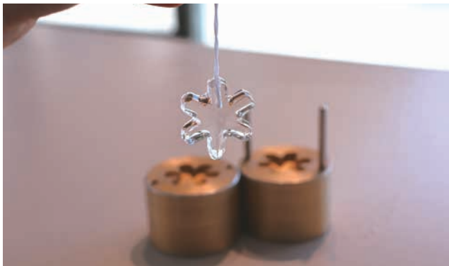
アルミニウム製の型で氷を挟むと、金属から伝わる熱で氷が溶けることを利用した科学実験。雪の結晶型をした氷のペンダントを作成することができる
