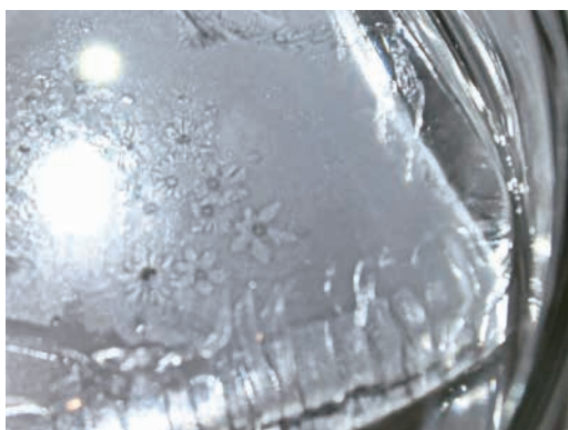
透明な氷が中から溶けていく時に見られるチンダル像。直径数ミリなので肉眼でもよく見える。雪の結晶と比べると落書きのようなユーモラスな姿だ。花の中心に見える点が真空の泡
