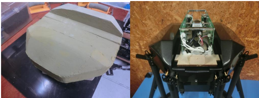
付図-5 Rainscope を搭載した全天候型ドローンの開発過程
