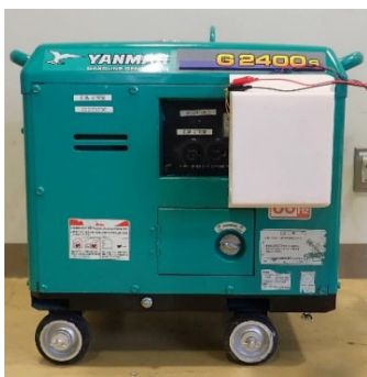
図 6 遠隔セル起動停止装置を取り付けた発電機
