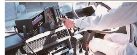
写真 3,4 除雪トラックの自動変速機構と広幅員路面整正装置
