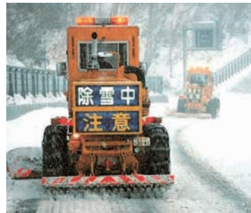
写真 2 除雪グレーダの粗面形成装置
